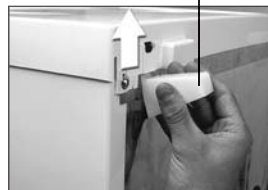
Рисунок 2 — Схема установки упора заднего
