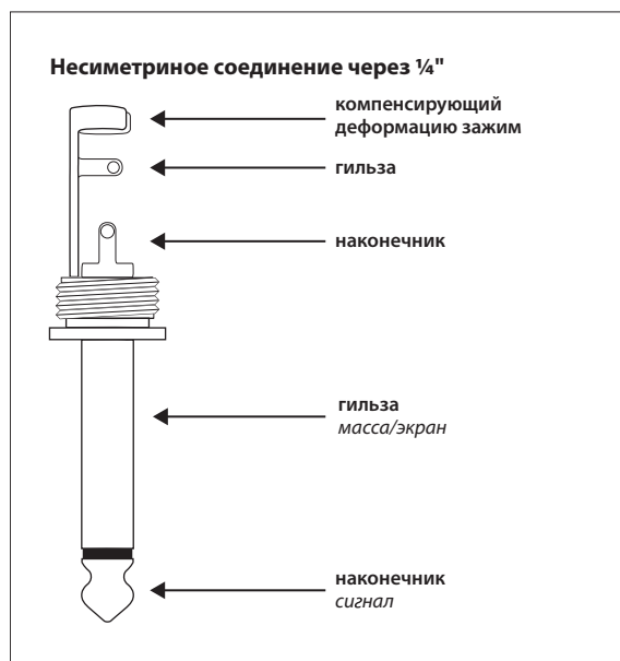
Rys. 3.3: 6,3-мм TS-штекер
