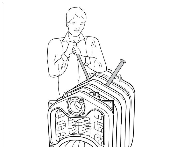
Рис. 27 Разъединение секций котла
