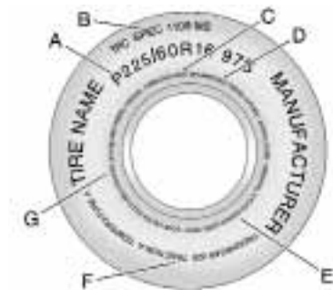
Пример маркировки шины неполноразмерного запасного колеса
