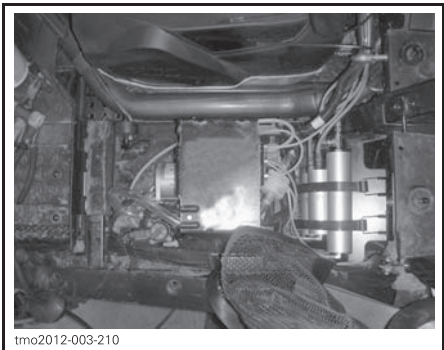
КОМПРЕССОР ПОДВЕСКИ С ПНЕВМОПОДКАЧКОЙ (ACS)
