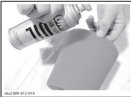
ТИПОВОЙ ВАРИАНТ — НАНЕСЕНИЕ МАСЛА НА ВОЗДУШНЫЙ ФИЛЬТР
