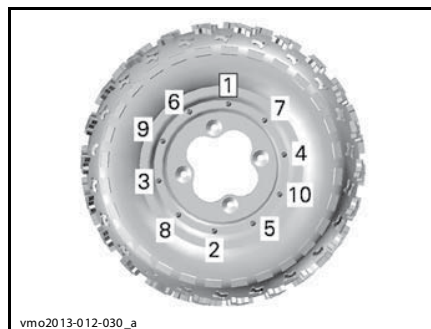
КОЛЕСА, ОСНАЩЕННЫЕ БЕДЛОКОМ С 10 БОЛТАМИ - ПОСЛЕДОВАТЕЛЬНОСТЬ ЗАТЯЖКИ (1-ЫЙ И 2-ОЙ ШАГИ)
