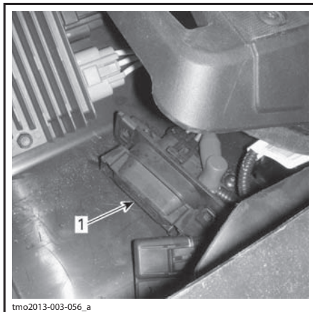
1. Дополнительный блок предохранителей
