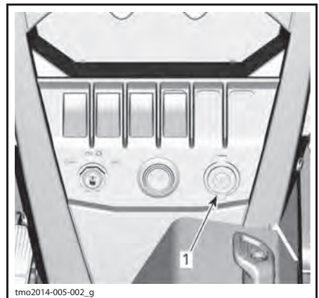
1. Электрическая розетка (12 В)
