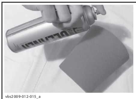
ТИПОВОЙ ВАРИАНТ — ЧИСТКА ПРЕДВАРИ- ТЕЛЬНОГО ФИЛЬТРУЮЩЕГО ЭЛЕМЕНТА
