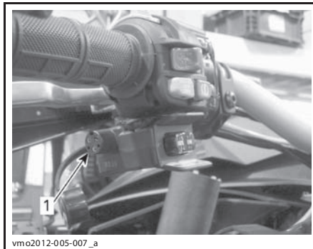
1. Разъём пульта дистанционного управления лебёдкой
