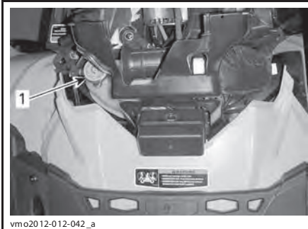
1. Расширительный бачок системы охлаждения двигателя
