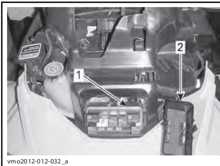
1. Передний блок предохранителей 2. Крышка переднего блока предохранителей
