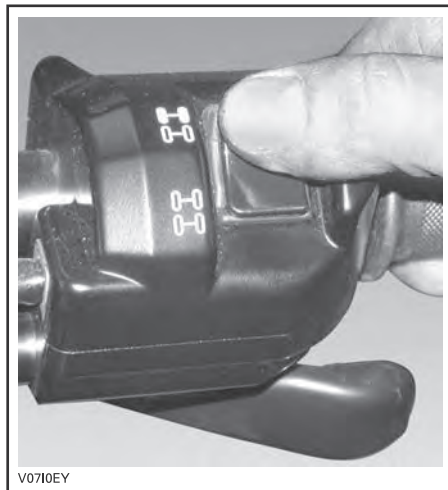
РЕЖИМ 2WD — ТИПОВОЙ ВАРИАНТ
