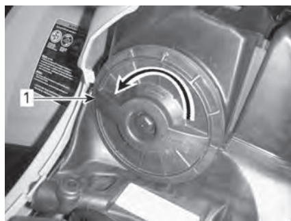
1. Крышка воздушного фильтра
