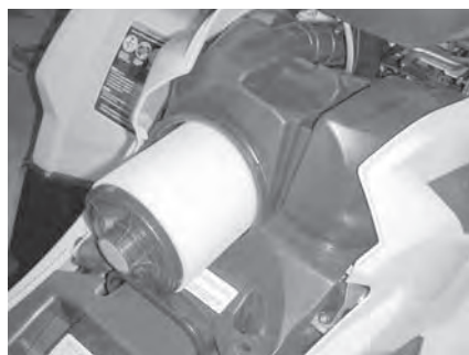
СНЯТИЕ ВОЗДУШНОГО ФИЛЬТРА
