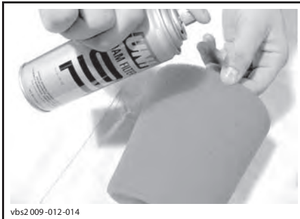
ТИПОВОЙ ВАРИАНТ — НАНЕСЕНИЕ МАСЛА НА ГУБЧАТЫЙ ФИЛЬТРУЮЩИЙ ЭЛЕМЕНТ
