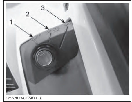
ПОЛОЖЕНИЯ ЗАМКА ЗАЖИГАНИЯ
