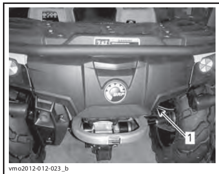
1. Крышка заднего багажного отделения
