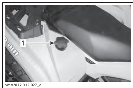
1. Пробка топливного бака
