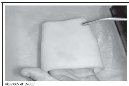
ТИПОВОЙ ВАРИАНТ — СУШКА ПРЕДВАРИТЕЛЬНОГО ФИЛЬТРУЮЩЕГО ЭЛЕМЕНТА
