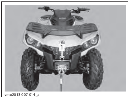
1. Расположение передней точки крепления
