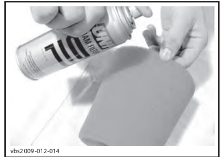
ТИПОВОЙ ВАРИАНТ — НАНЕСЕНИЕ МАСЛА НА ПРЕДВАРИТЕЛЬНЫЙ ФИЛЬТРУЮЩИЙ ЭЛЕМЕНТ
