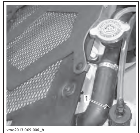
1. Крышка расширительного бачка
