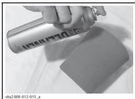
ТИПОВОЙ ВАРИАНТ — НАНЕСИТЕ ОЧИСТИТЕЛЬ НА ПРЕДВАРИТЕЛЬНЫЙ ФИЛЬТРУЮЩИЙ ЭЛЕМЕНТ
