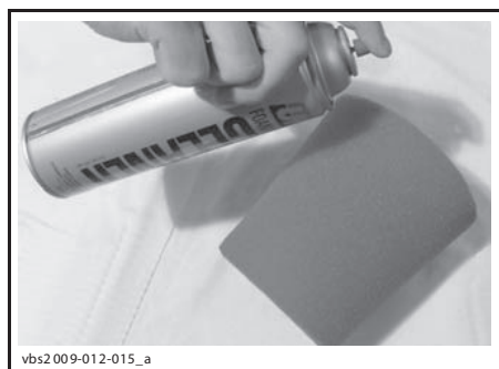
ЧИСТКА ПРЕДВАРИТЕЛЬНОГО ФИЛЬТРУЮЩЕГО ЭЛЕМЕНТА (ВНУТРИ И СНАРУЖИ)
