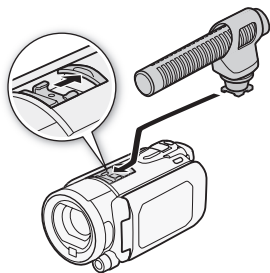
Пример. Установка дополнительно приобретаемого направленного стереомикрофона DM-100.
