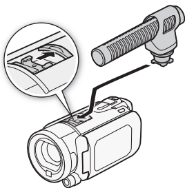
Пример. Установка дополнительно приобретаемого направленного стереомикрофона DM-100.
