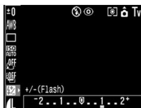
Пример настройки вспышки
