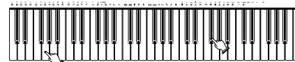
Удерживайте клавишу нажатой, чтобы задать основной тон аккорда. Нажмите клавишу, чтобы задать тип аккорда.
