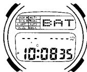
Низкая мощность батареи
