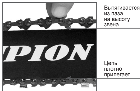
Рис. 6 Регулировка натяжения цепи
