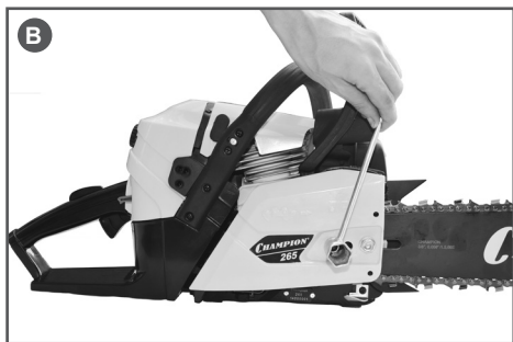
Рис. 5 Затяжка гайки крепления шины
