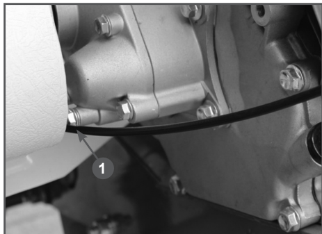
Рис. 22 Замена масла в редукторе двигателя
