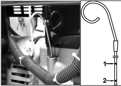
Рис. 8 Проверка уровня масла в картере
