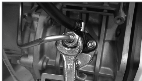
Рис. 12 Удаление воздуха из топливного насоса
