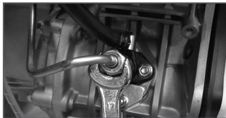
Рис. 12 Удаление воздуха из топливного насоса
