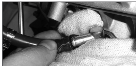
Рис. 10 Удаление воздуха из топливного шланга
