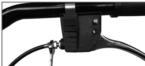
Рис. 10 Установка регулировочной муфты троса газа
