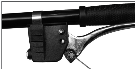
Рис. 9 Установка наконечника троса газа
