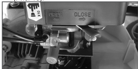
Рис. 16 Воздушная заслонка карбюратора закрыта
