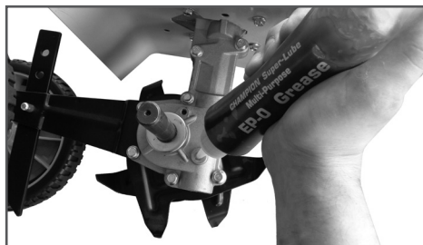
Рис. 24 Добавление смазки в корпус редуктора
