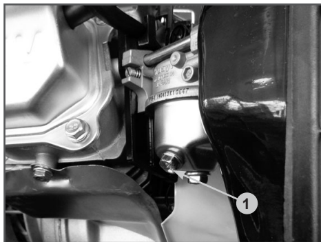
Рис. 17 Слив топлива из карбюратора
