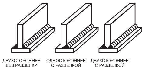
Рис. 13 Виды тавровых соединений
