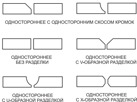
Рис. 12 Виды стыковых соединений
