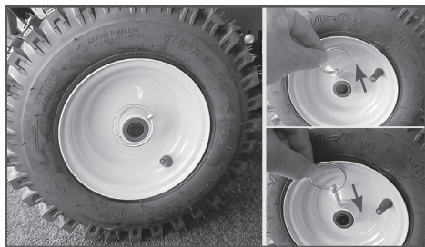
Рис.26 Установка шплинта на левом колесе
