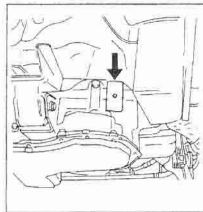
Рис. 10.1.7. Расположение номера автоматической коробки передач.
