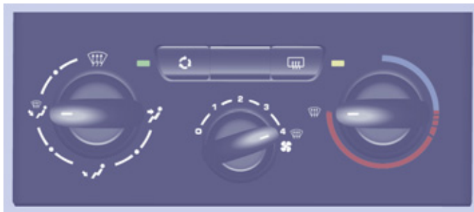
Панель управления отоплением
