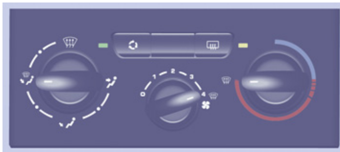
Панель управления отоплением
