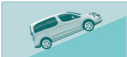
Система помощи при трогании на подъеме
