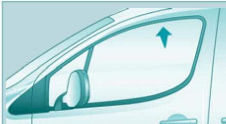
Защита от заземления стеклом
