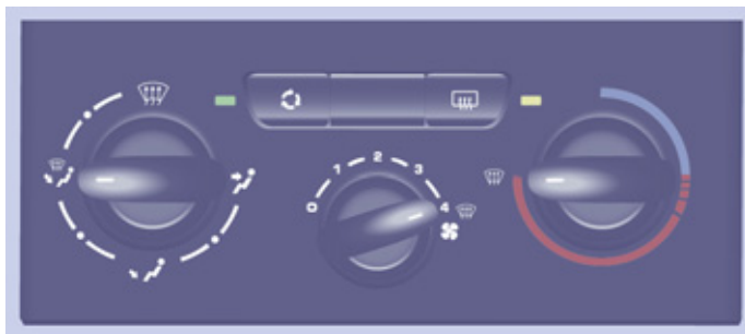
Панель управления отоплением
