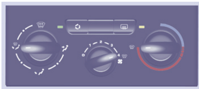
Панель управления отоплением
