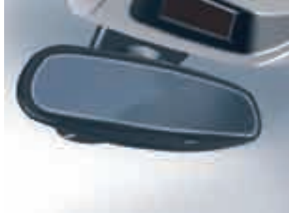
166.10 Зеркало заднего вида с автоматической регулировкой "день"/"ночь"
