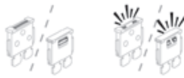
Исправный предохранитель Сгоревший предохранитель
