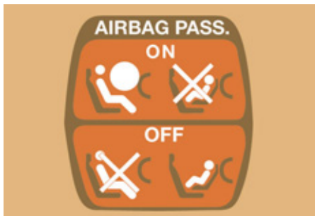
Отключение подушки безопасности пассажира ("OFF")
