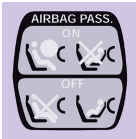
Отключение подушки безопасности пассажира ("OFF")
