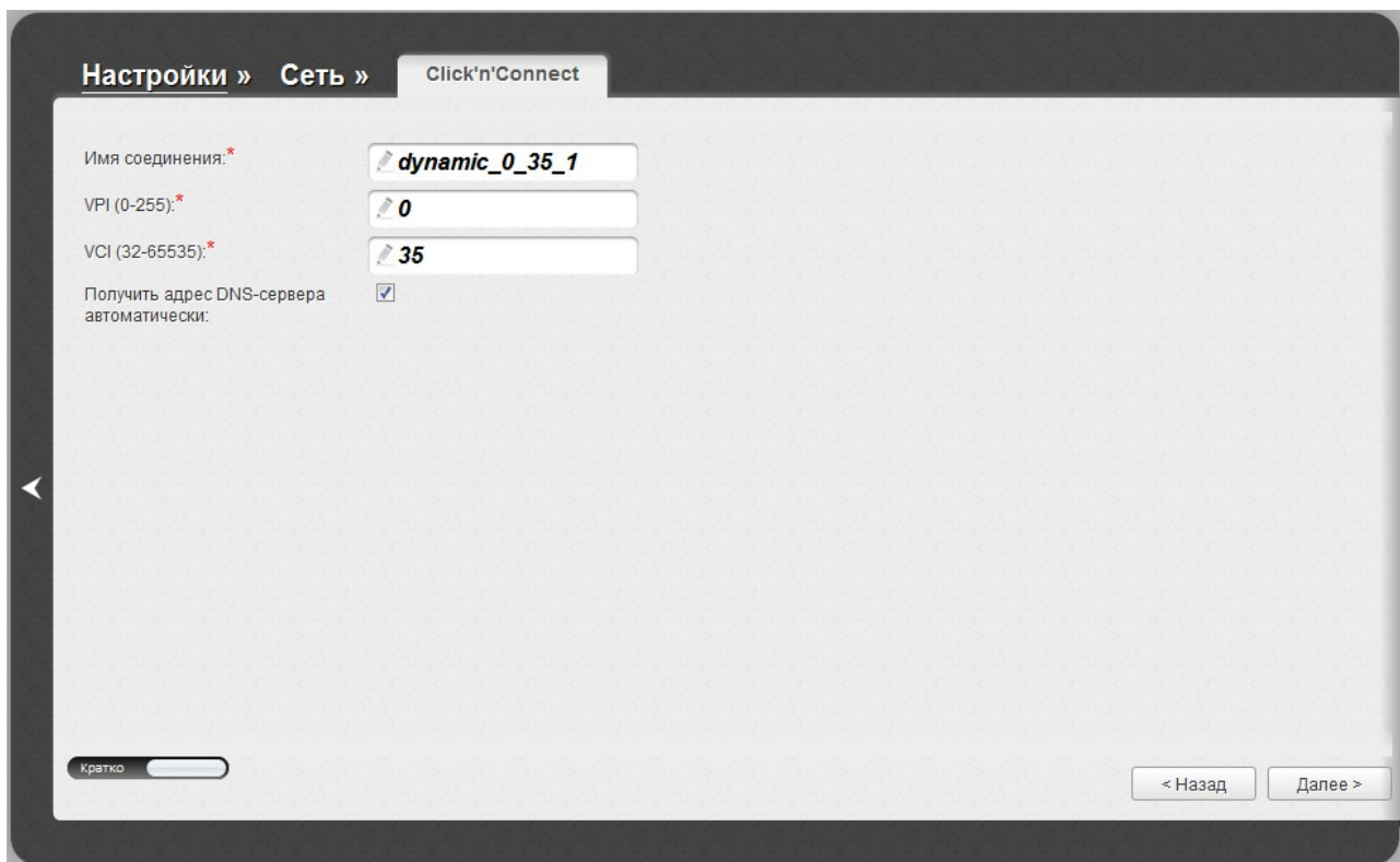
Рисунок 38. Настройка WAN-соединения типа Динамический IP.
