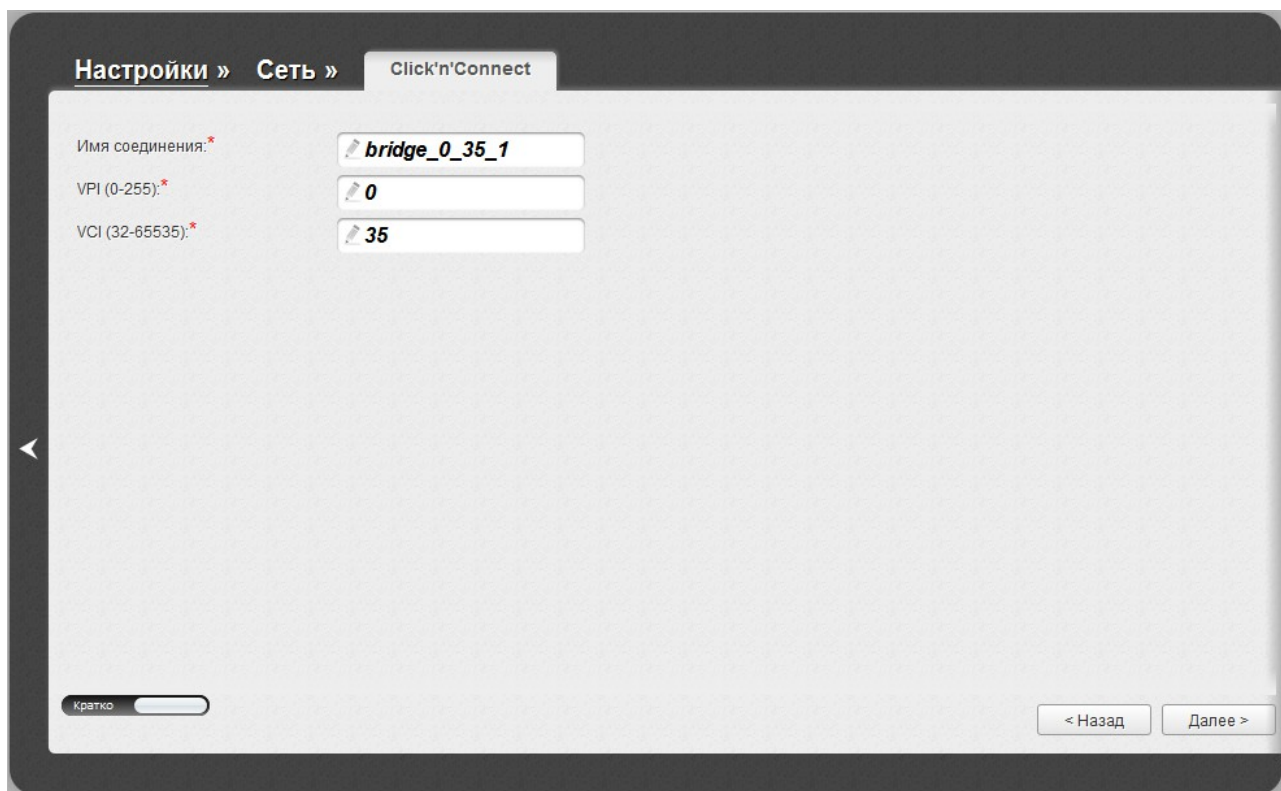
Рисунок 42. Настройка WAN-соединения типа Bridge.
