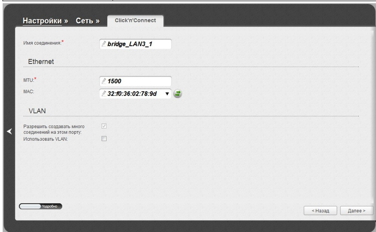
Рисунок 44. Настройка WAN-соединения типа Bridge. Экспертный режим настроек. Раздел Ethernet.
