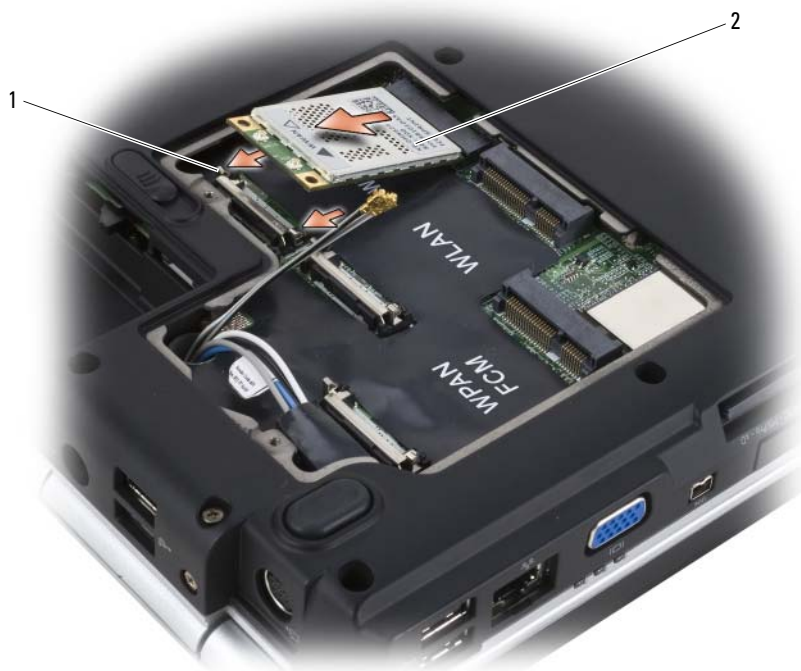
1 металлические защелки (2) 2 плата WWAN
