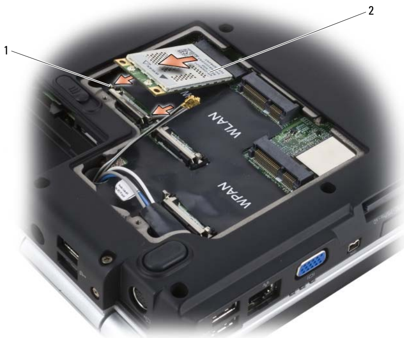
1 металлические защелки (2) 2 плата WWAN
