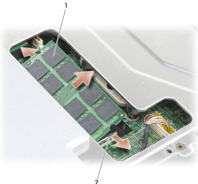
1 модуль памяти (DIMM A) 2 фиксатор (2)
