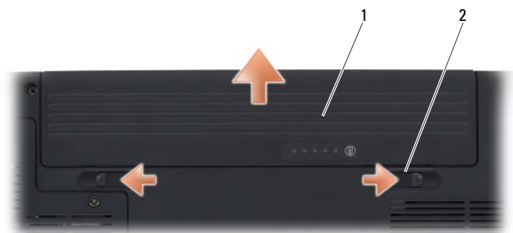
1 аккумулятор 2 защелка для отсоединения аккумулятора (2)
