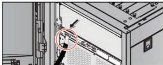
Рис. 5-33. Отсоединение кабеля ЖК-дисплея
