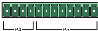
Рис. 4-7. Сухие контакты батареи
