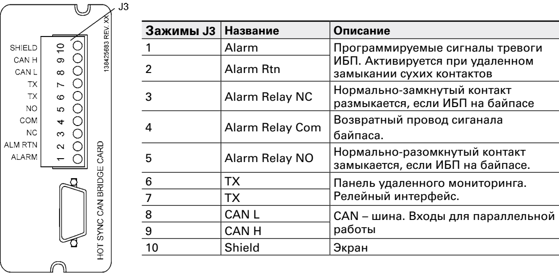
Рисунок 50. Плата XSlot Hot Sync и контактный интерфейс
