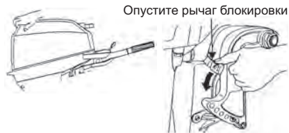
Опустите рычаг блокировки
