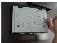
④ Зафиксируйте HDD винтами
