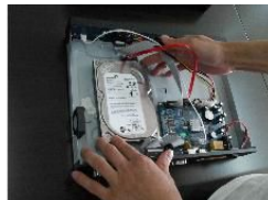
③ Подключите HDD кабелями к плате
