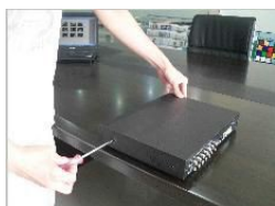
① Открутите винты на корпусе
