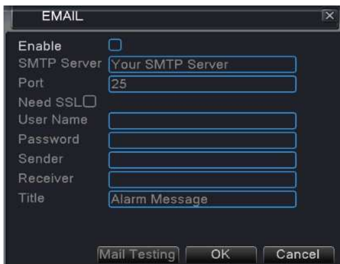
Рис. 4.19 Настройка электронной почты
