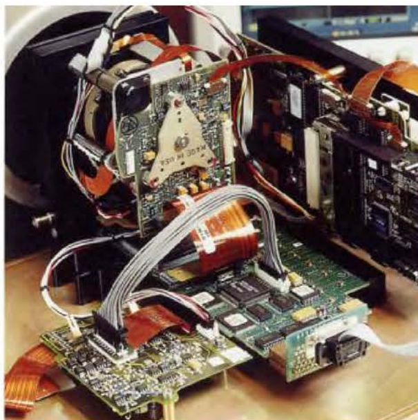
Рисунок 29.3 СПЕВА: Разработка электроники системы; СПРАВА: Тестирование детектора МФП
