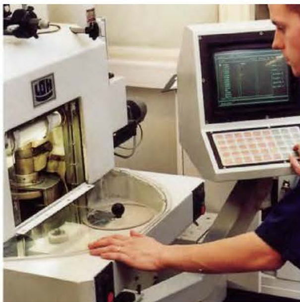
Рисунок 29.4 СПЕВА: Алмазно-токарный механизм; СПРАВА: Полирование пина
