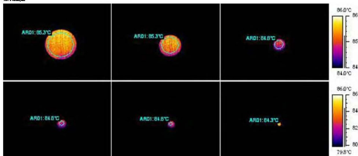
Рисунок 28.19 Измеренная температура абсолютно черного тела с температурой +85°C для возрастающих значений расстояния
