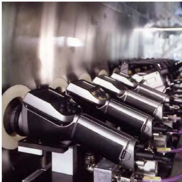
Рисунок 29.5 СЛЕВА: Тестирование инфракрасных камер в климатической камере; СПРАВА: Робот для тестирования и калибровки камеры
