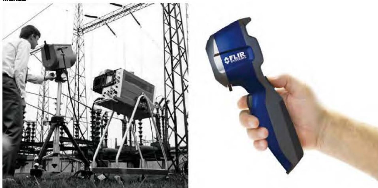
Рисунок 29.2 СЛЕВА: Thermovision® модель 661 выпуска 1969 года. Эта камера весила около 25 кг, осциллограф – 20 кг, а штатив – 15 кг. Кроме того, оператору требовался генератор переменного напряжения на 220 В и сосуд Дьюара на 10 л с жидким азотом. Слева от осциллографа видна фотоприставка Polaroid (6 кг). СПРАВА: FLIR i7 выпуска 2009 года. Вес: 0,34 кг вместе с аккумулятором.
