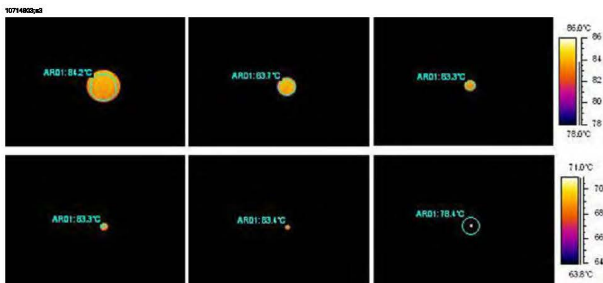
Рисунок 28.20 Измеренная температура абсолютно черного тела при температуре +85°C для возрастающих значений расстояния (объектив 24°)
