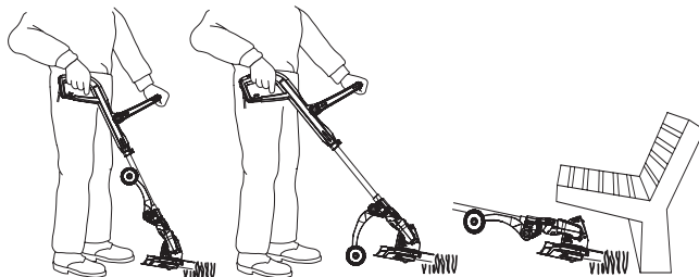
Рабочее положение 1: Стрижка без колес Рабочее положение 2: Стрижка с колесами Рабочее положение 3: Стрижка под препятствиями
