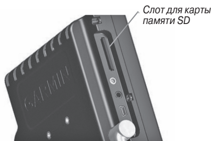
Слот для карты памяти SD в приборе GPSMAP 695/696
