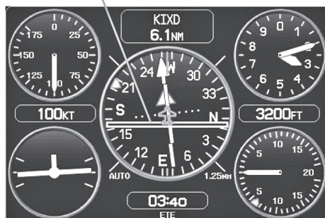
Индикатор VNAV (приборная панель)
