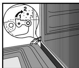
1 Шарнир дверцы при нормальном использовании
